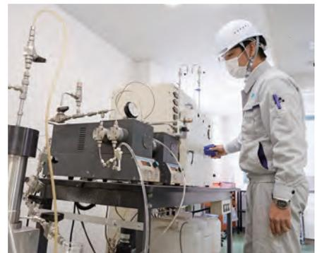
ナノ粒子の合成や無機粒子の造粒など、顧客に代わって超臨界技術装置による試験・試作を行っている。
