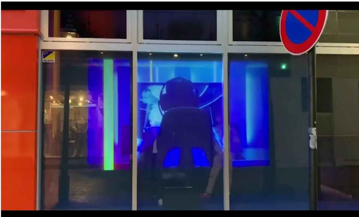
パルミルスクリーンをガラスに貼り付け、コンテンツをプロジェクターで投影
