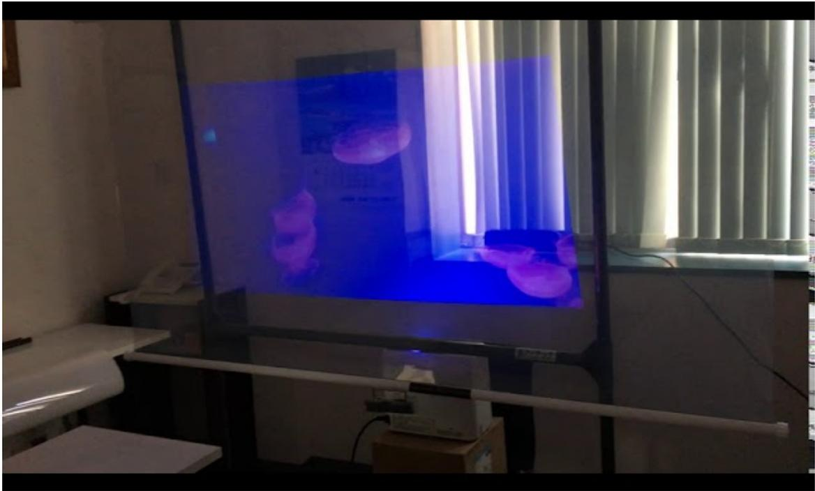
パルミルスクリーンをロールスクリーンに加工し、コンテンツをプロジェクターで投影
