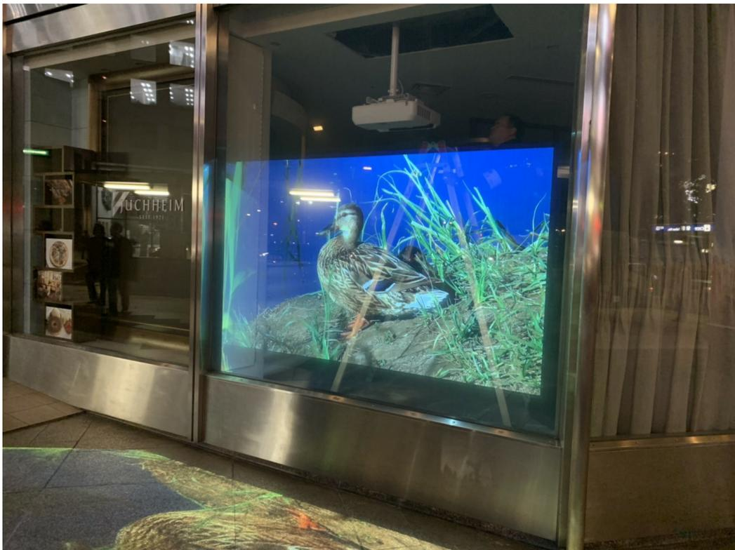
ガラスにパルミルスクリーンを貼り付け、プロジェクターで投影。「ウインドウサイネージ」として使用
